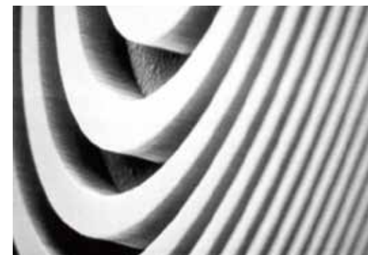
菲涅尔波带片，扫描电子显微镜。
