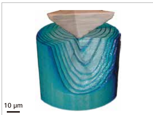
SiC:BN 复合纤维的原位压缩压痕失效。使用 Xradia 810 Ultra 和 Ultra 原位力学加载台成像。
