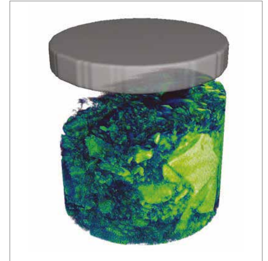
在原位力学加载台实验中处于不同压缩阶段的弹性体，（左：未压缩，中：压缩状态下，右：压缩后）。使用 Xradia 810 Ultra 成像（比例条适用于所有三张图像）。
