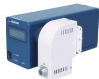
**ESC-143 | JASCO 校准光源 D<sub>2</sub>**
