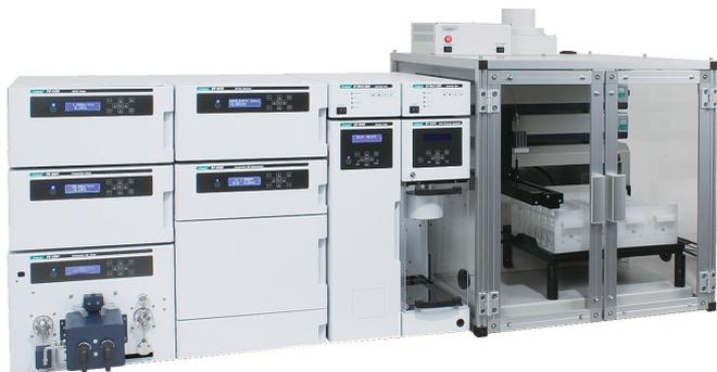
半制备 SFC 系统，将超临界二氧化碳作为移动相，缩短了萃取后的溶液浓缩工序，大大消减了总体运作成本。样品回收部采用了半制备 SFC 的馏分收集器。气液回收采用了小型旋风分离器（专利，JP 4675406 \$ 8327725，专利申请中 EP 09171172）。另外，通过 ChromNAV Ver.2 数据处理软件，实现对馏分收集器的控制，可设定多种多样的分化条件，实现便捷，简易的分化操作。
