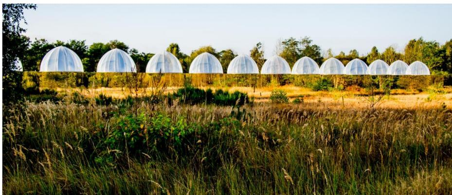
Eco-Cell 因提供精确的环境控制和在线测量各种尺度的生物、生态系统的状态及活动 (flux)，该设施在复杂的自然状态研究和简化的实验室试验之间搭建了桥梁。因将生态系统内置在一个实验箱中，它可以利用这个限制优势，精确地测量不同生态系统单元中的分子交换信息，包括和大气的交换信息。
